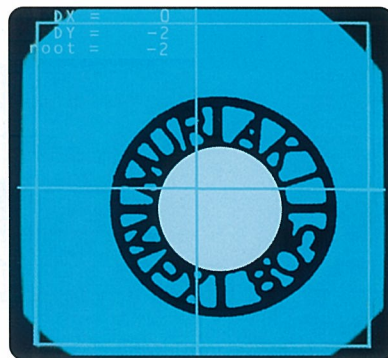
●穴明け後 再検査機能により穴位置精度を表示。(1μm単位) ●After Drilling Indication of positioning (μm)
